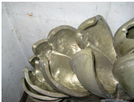
Abbildung 24: Wo möglich, sollte Wasserkraft durch ein Kleinwasserkraftwerk immer genutzt werden (Schaufelrad des KWKW auf der Sulzenauhütte/Stubai Alpen).
